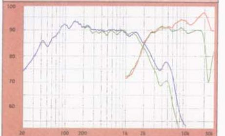
Die Chassis zeigen perfekte Frequenzgänge und symmetrische Filterflanken. Der große Hochtöner schafft eine beachtliche obere Eckfrequenz und der Tieftöner sogar 90 dB Schalldruck
